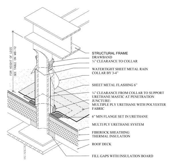
ADUREL POLYMAR ROOFING SYSTEMS **EQUIPMENT STAND FLASHING**
